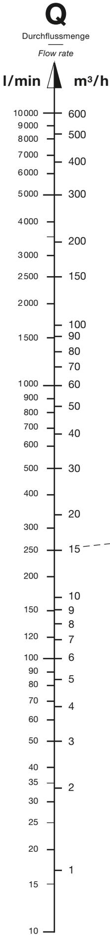
Diese Tabelle soll Ihnen bei der Wahl der erforderlichen Schlauchgröße 'ID' je nach gewünschter Durchflussmenge behilflich sein. Bei den angegebenen Werten ist der durch die Reibung innerhalb des Schlauches auftretende Druckverlust nicht berücksichtigt. Zur Bestimmung des Druckverlustes dient die Tabelle auf Seite 104.
