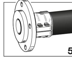
**Leitfähigkeit:** 'OHM'-Type nach EN 1762. Elektrischer Widerstand R < 10<sup>6</sup> Ohm, gemessen zwischen den Schlaucharmaturen. Hierzu müssen bei der Armaturenmontage die metallischen Leiter **nicht** angeschlossen werden.
