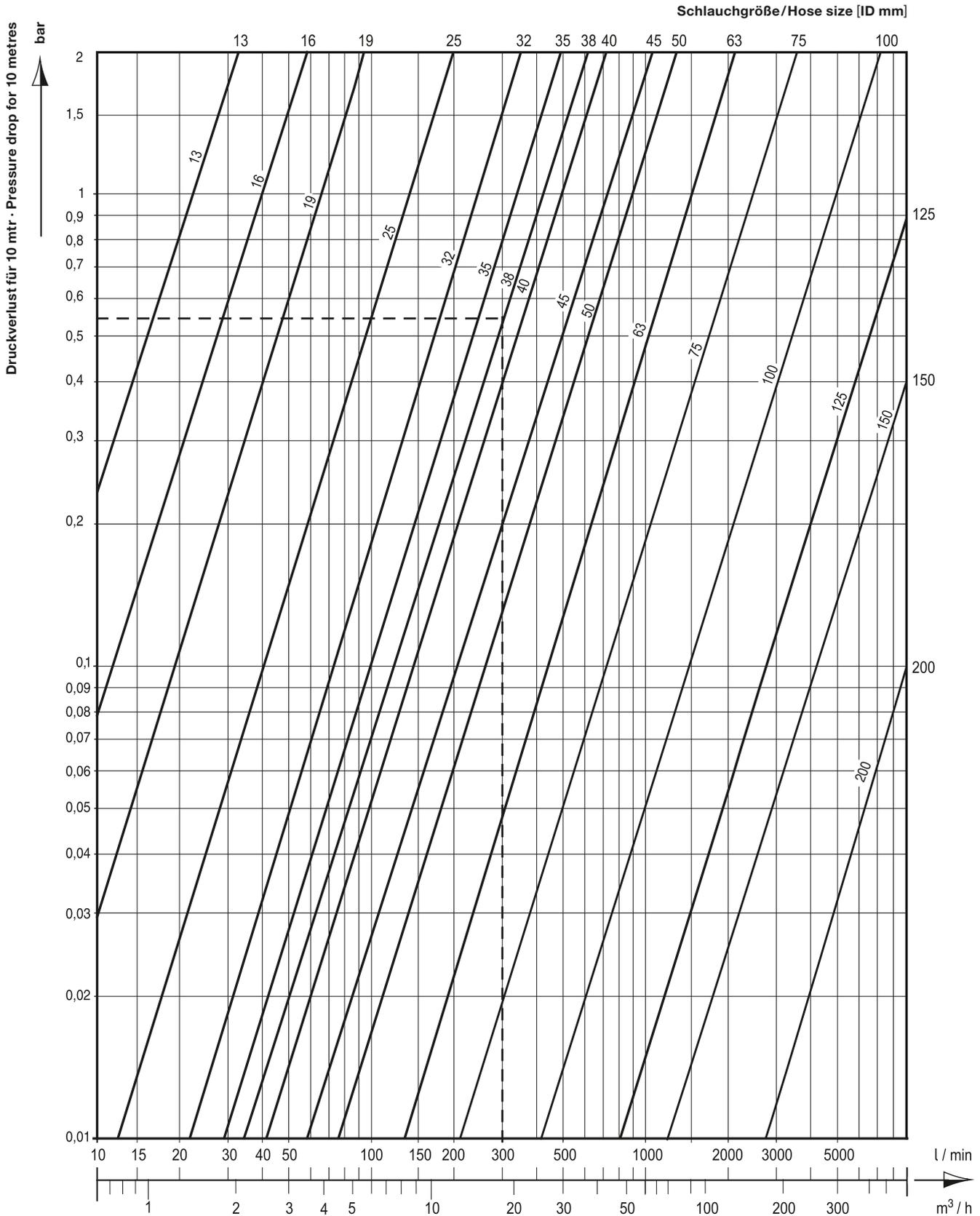
**Beispiel:** Gesucht wird der Druckverlust eines 50m langen Schlauches mit 38 mm innerem Durchmesser (ID) bei einer angenommenen Durchflussleistung von 300 Liter je Minute.
